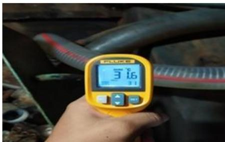
Gambar 5. Suhu pipa penyediaan air tawar
